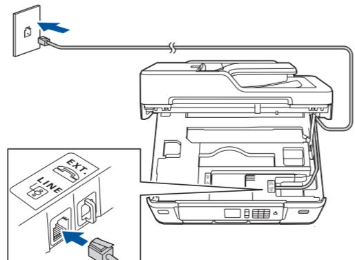
Подключите телефонный провод. Подключите провод к гнезду с маркировкой LINE и выведите провод наружу через заднюю стенку устройства.
