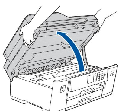
Поднимите крышку сканера.
