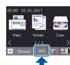
Выберите SSID (имя сети) беспроводной точки доступа или маршрутизатора и введите сетевой ключ (пароль).
