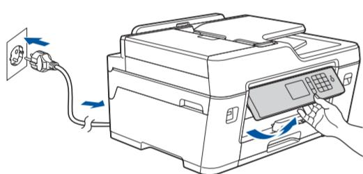
Подключите шнур питания. Устройство включится автоматически.
