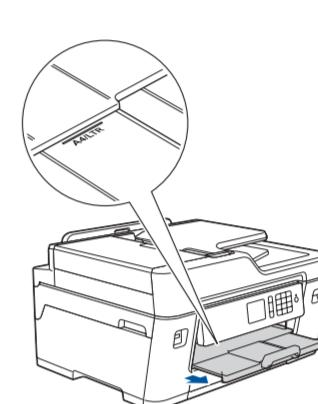
Извлеките опорную панель до щелчка.
