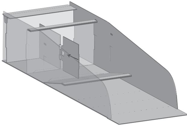
**5** Установите верхнюю перегородку шипом в прорезь средней полки.
