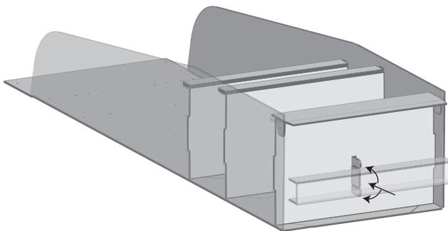
**7** Согните опору «П»-образно, установив опору снизу витрины в прорези нижней перегородки.
