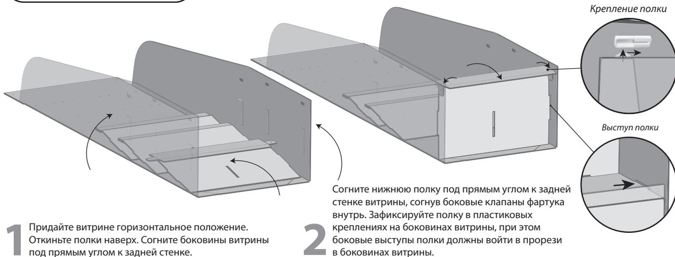
**1** Придайте витрине горизонтальное положение. Откиньте полки вверх. Согните боковины витрины под прямым углом к задней стенке.
