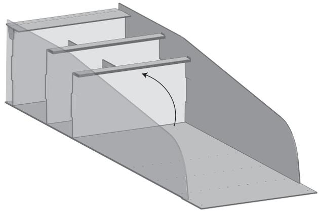
**6** Согните верхнюю полку под прямым углом к основанию, надев полку прорезью на шип верхней перегородки. Зафиксируйте полку в пластиковых креплениях на боковинах витрины, при этом боковые выступы полки должны войти в прорези в боковинах витрины.
