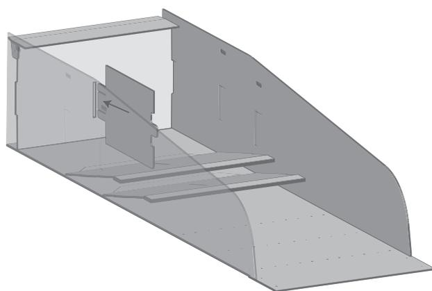
**3** Установите нижнюю перегородку шипом в прорезь нижней полки.
