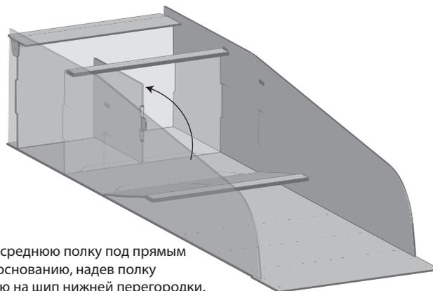
**4** Согните среднюю полку под прямым углом к основанию, надев полку прорезью на шип нижней перегородки. Зафиксируйте полку в пластиковых креплениях на боковинах витрины, при этом боковые выступы полки должны войти в прорези в боковинах витрины.
