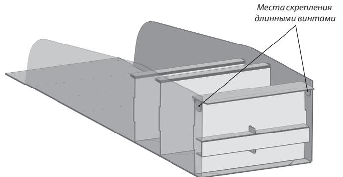
**8** Скрепите боковины фартука нижней полки с боковинами витрины с помощью двух винтов.
